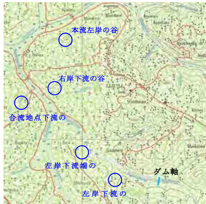
図 3-6-2-10 テストピット掘削調査位置
