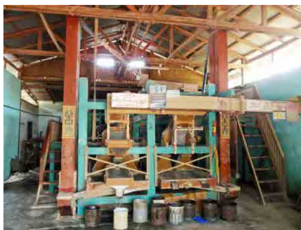
小規模精米工場 国産の機械で構成された伝統的な精米プラント。アンダーランナー式 舂攪り機と研削式精米機を中心とした機種構成である。
