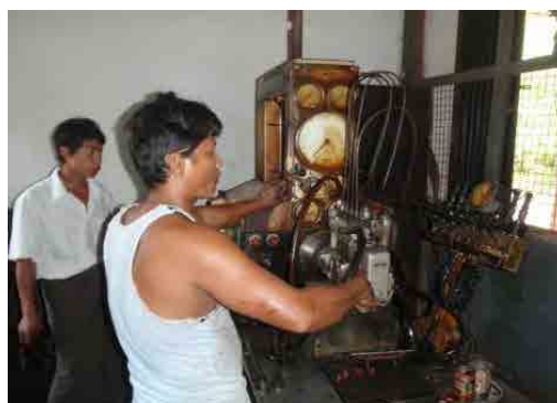
ディーゼルエンジンの燃料噴射ノズルの調整
