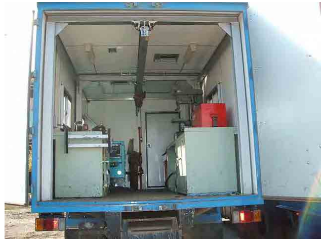
Mobile Workshop（フェーズ1で供与） クレーン、発電機、コンプレッサ、溶接機、作業台、工具棚など
