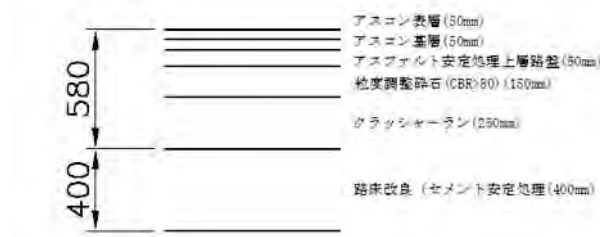
図 3-2-14 取付道路の舗装構造案
