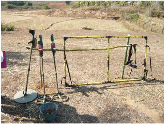
不発弾探知機：現在使用されている不発弾探知機 3 種類。左から、Minelab、Vallon、Ebinger (Large-Loop)。全体的に数が不足している。
