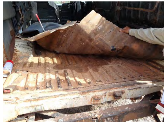
車内：丁寧に使われているものの、錆で腐食が始まっており、走行距離は約 37 万キロに達している車両もある。使える状態に保つのが厳しい。
