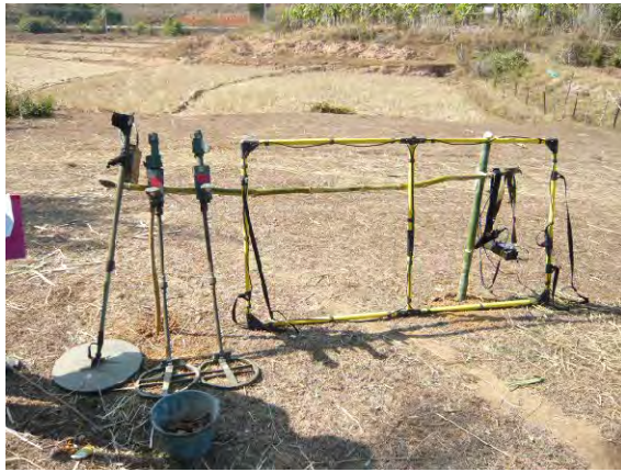
不発弾探知機：現在使用されている不発弾探知機 3 種類。左から、Minelab、Vallon、Ebinger (Large-Loop)。全体的に数が不足している。
