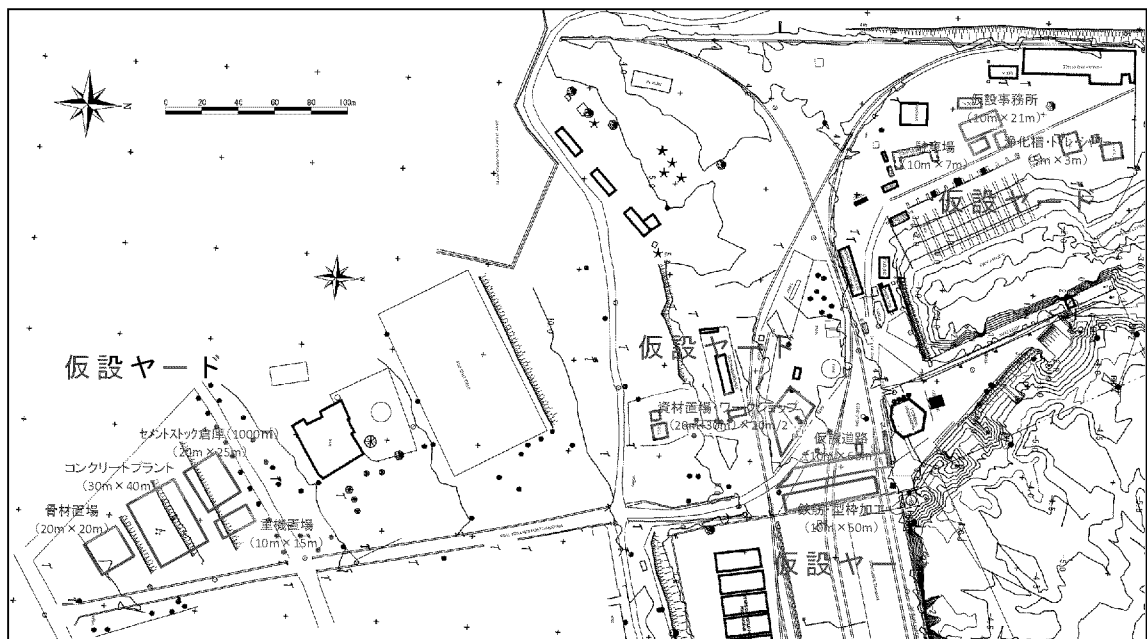
図 3.2.4.1-4 仮設ヤード及び仮設道路の配置図
