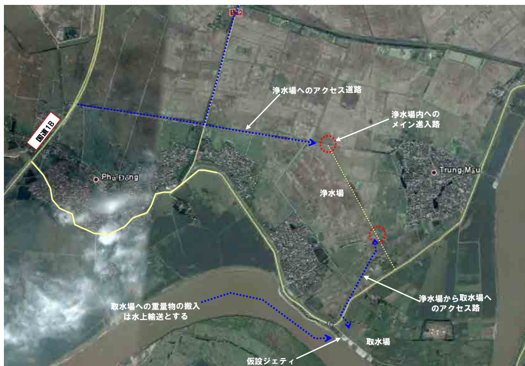
図-3.6.2 工事用進入路
