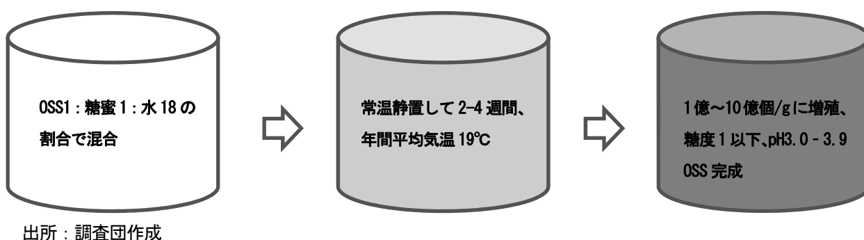
図 21 OSP から OSS を製造する工程
