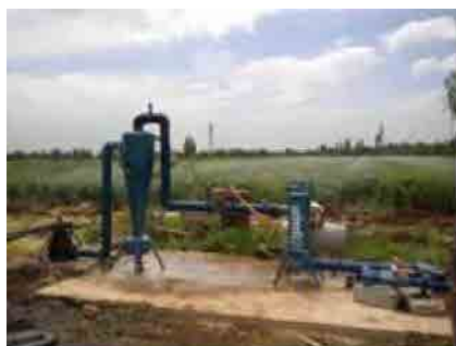
Beit Sabar（ダマスカス郊外県） コントロールユニット サイクロン・フィルター付き
