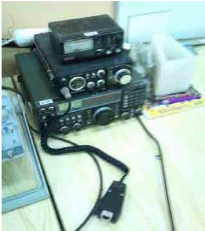
30年以上前に生産された日本製のアマチュア無線用トランシーバが信号発生器の代わりに使用されている（無線通信実験室）。
