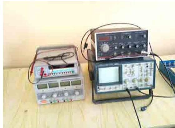
デジタルマルチメータ、オシロスコープ、信号発生器などの基本計測器は丁寧にメンテナンスされているが、老朽化し校正もなされていない（基礎電子実験室）。
