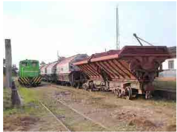
【Blitta駅】停車中の鉄鉱石ホッパ車。駅に荷役設備はなく、貨物取扱いの作業効率は低い。
