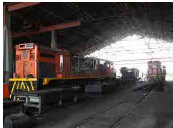
現在稼働しているディーゼル機関車はカナダ製（1,600Hp）
