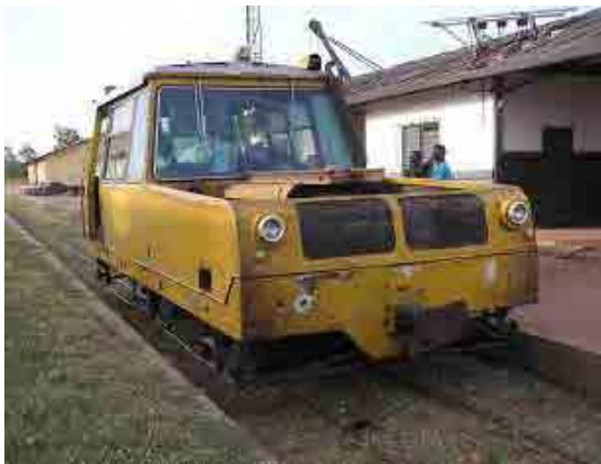
【Blitta駅】スイス（ローザンヌ）のMATISA製の軌道検測車が留置されていた。
