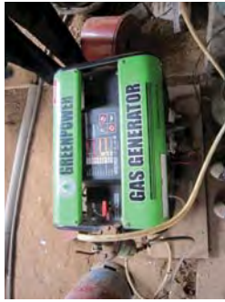
ガスエンジン発電機 (左側のボンベがLPG。右側の容器が硫化水素除去用フィルター)
