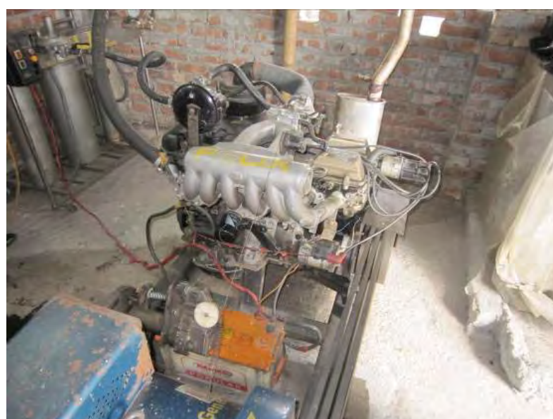
図 29: 自動車用ガソリンエンジンのバイオガスエンジンへの転用事例
