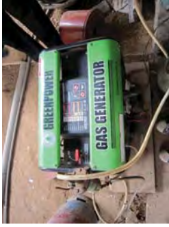
中国製ガスエンジン発電機
