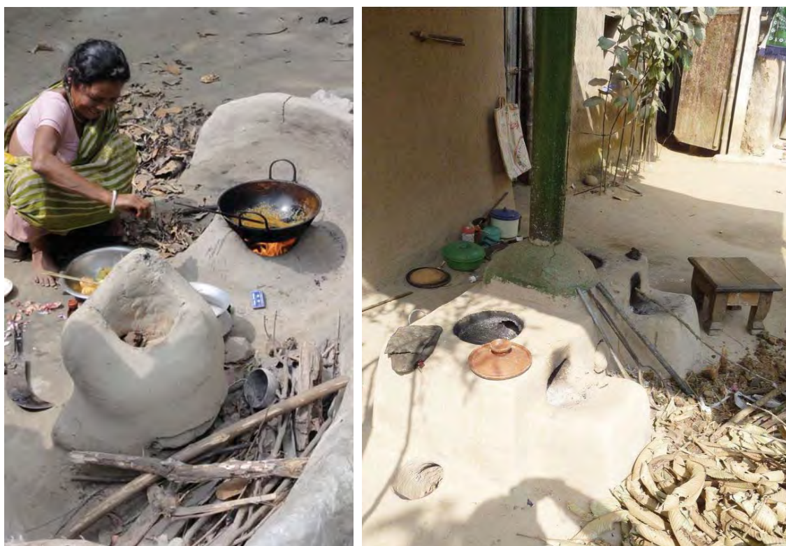
図 25: 旧来型の三点支持型かまど(左)と改良かまど(粘土製)(右)
