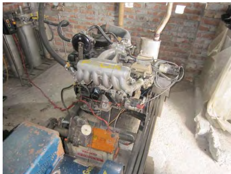
図 29: 自動車用ガソリンエンジンのバイオガスエンジンへの転用事例
