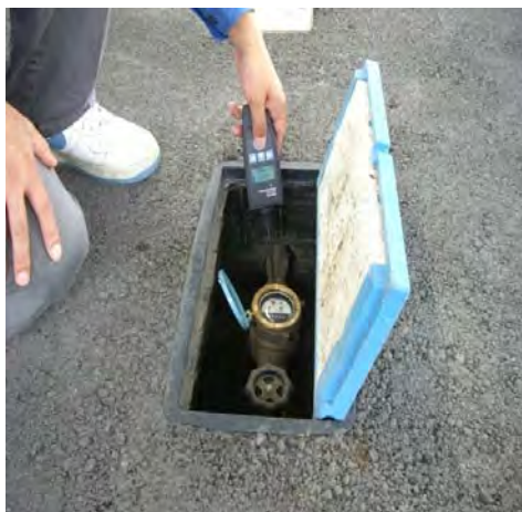
図 II-2.19 TS 漏水チェッカー：時間積分式漏水探知器
