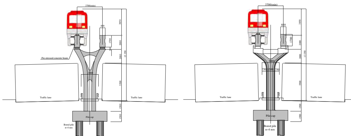
Figura 5-36 Seção Transversal Típica dos Pilares do Monotrilho
