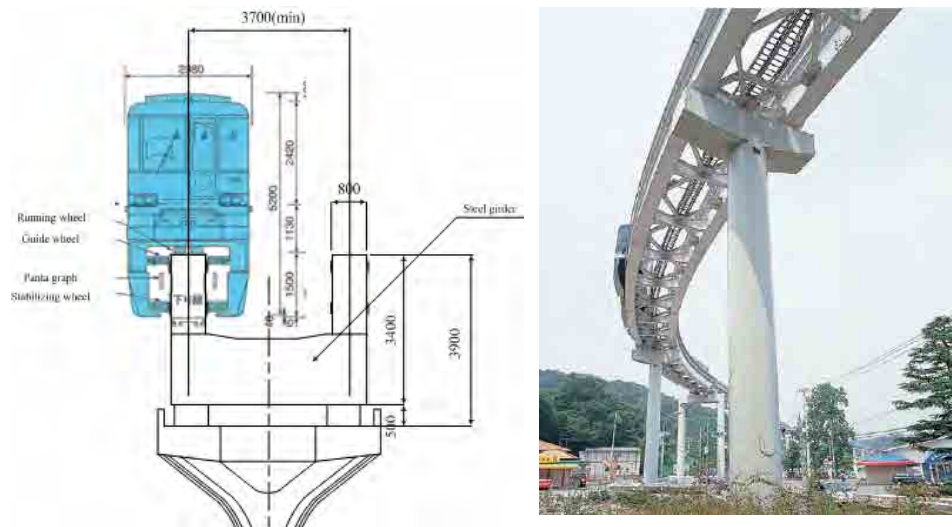
Figura 6-2 Desenho de Seção Típica e Foto da Viga de Aço
