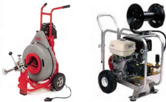
図 3-27 携行型の管路清掃機材の例
