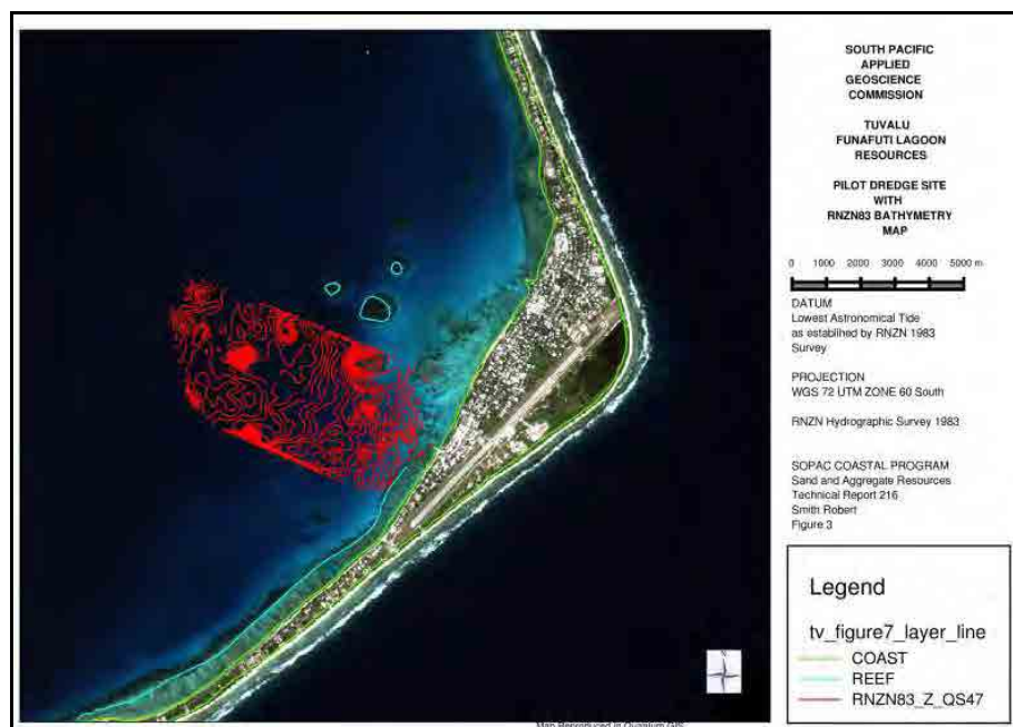
図 3-3-2 フォンガファレ島ラグーン側の深浅測量図(1)
