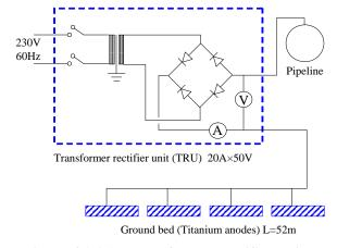
Figure 4.2.26 Transformer rectifier unit
