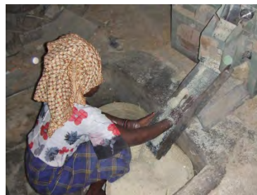
ワンパス精米機排出樋に金網を張って糠と極小碎米の分離で品質向上
