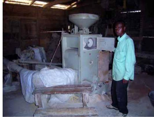
Ashanti州、Kumasi中央市場のRice Mill Complex。サタケのワンパス式籾摺精米機の賃搗き業者。エンゲルバーグ式に比べると格段に碎米率が低いが、前に精選処理機がないので、夾雑物の除去ができない。
