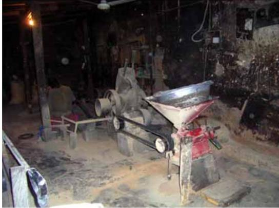
Upper West州、Wa中央市場内の賃搗き業者。モーター駆動のエンゲルバーグ式精米機を使用している。籾摺と精米を同時に同工程かつ高圧力で行うため、碎米発生が非常に多く、精米歩留まりが悪い。
