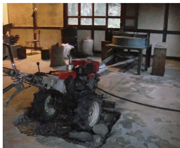
トウモロコシ圧扁機の動力として使われる 耕耘機 (モンガル県セリン郡ジャドン村)
