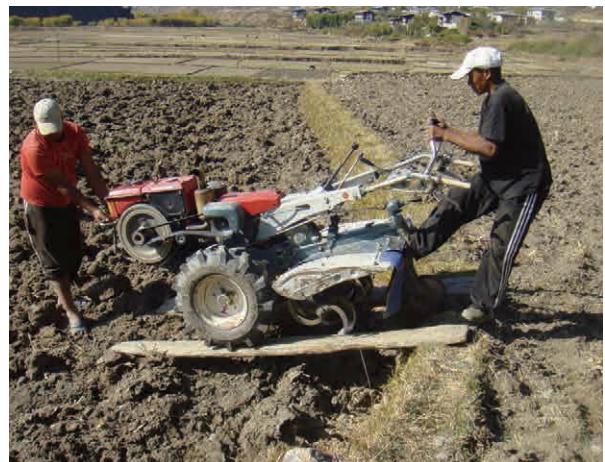
段差のある圃場も 2 枚の板を利用して 上げ下ろしする (同左)
