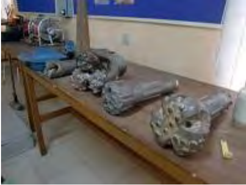
連邦水資源研修所で講義に使用している掘削用ビット。
