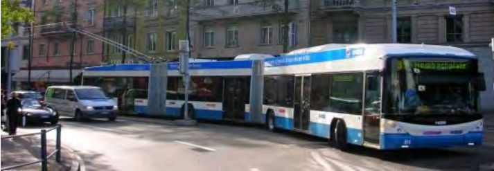
Gambar 6.4.38 Set beruntun dari dua articulated bus dengan penggerak listrik menyerupai sistem LRT
