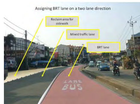
Gambar 6.4.9 Dengan BRT mengambil 50% ruang jalan kapasitas meningkat menjadi 7200 penumpang p.h.
