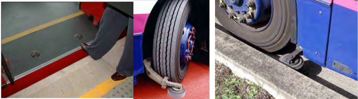
Gambar 6.4.24 Panduan roda untuk memprediksi docking pada shelter
