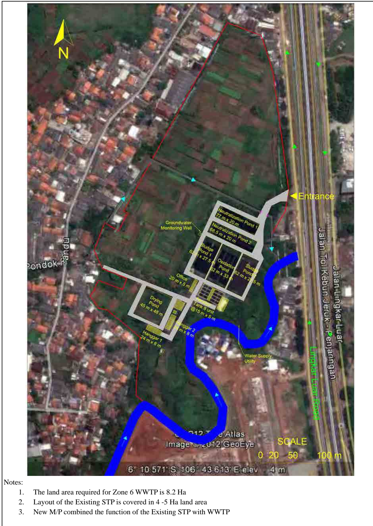
図 D7-7 処理区 No.6 (Duri Kosambi) の処理場候補地のレイアウト
