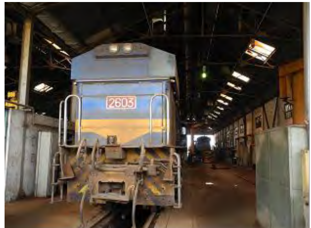
1992 年にフランス (アルストム) で製造された 2603 号機は、軸重が 16 t であり、構造物が耐え られないため使用されていない。 (タコラディ車両基地)
