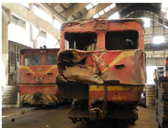
衝突事故で廃車となった機関車 （1657号機：ドイツ製）
