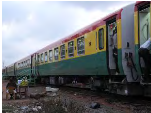
ドアは車端に 2 カ所設けられている。（シャングリラホテル駅）
