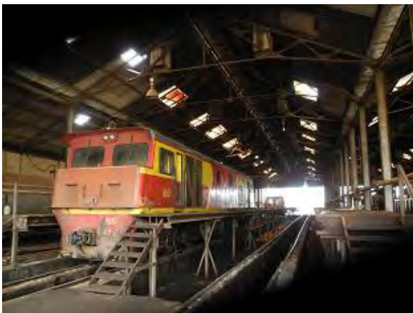
マンガン輸送用の 1661 号機。軸重は 14.5 t である。 (タコラディ車両基地)
