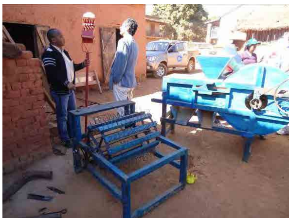
農業機械研修受講者が製造した足踏み式 脱穀機と唐箕 (とうみ)
