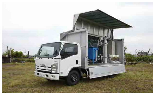
図 5-5 車載式膜ろ過装置(標準浄水量 50m 3 /日)
