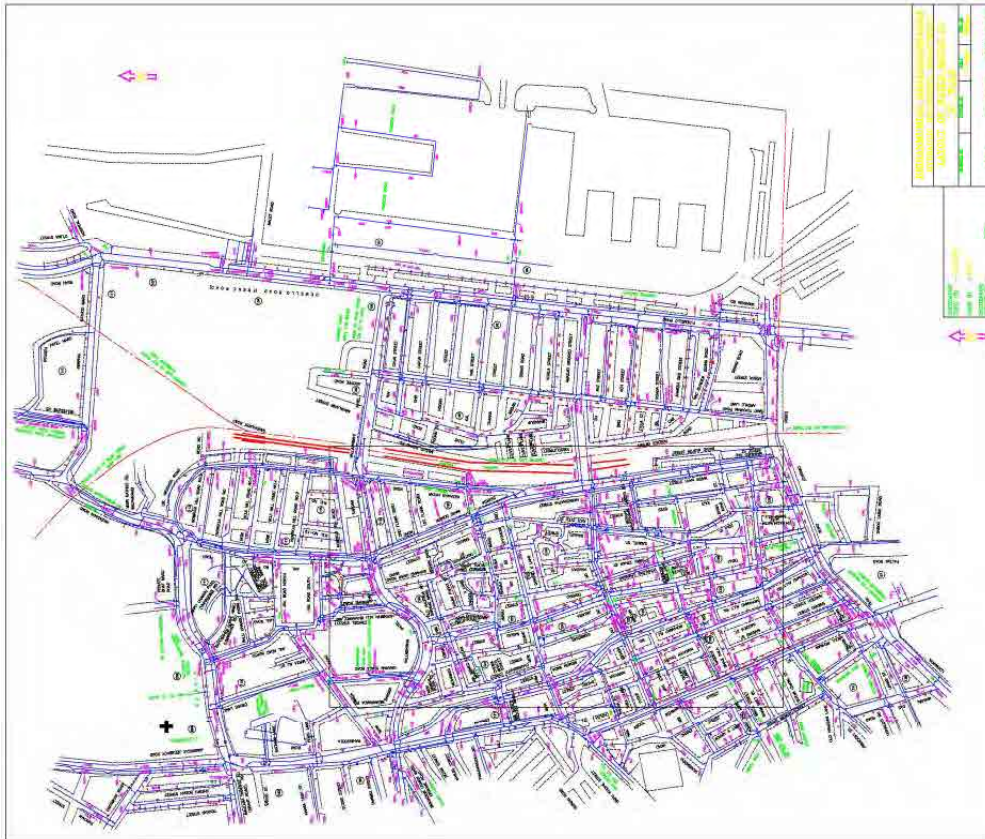
図 3.5: AutoCAD で作成されたムンバイ市の配水管網図 (例)
