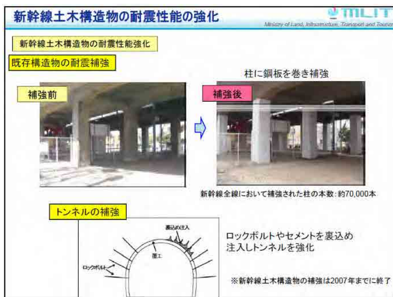
図 3-15 新幹線土木構造物の耐震性能の強化
