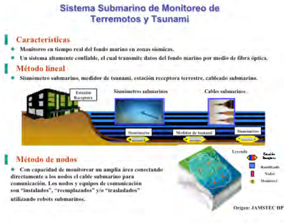
Figura 4.3.4 Sistema de Observación Submarina
