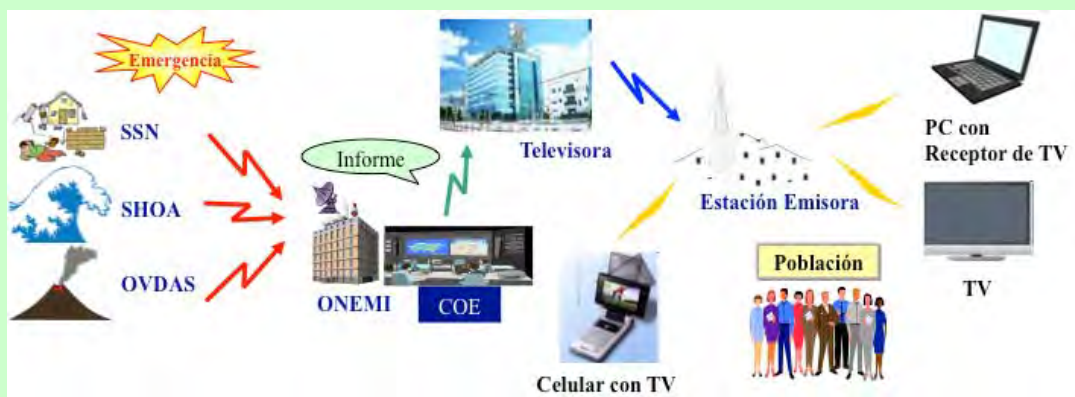
Figura 11 Emisión de Alerta de Emergencia mediante el uso de los Canales Digitales Terrestres
