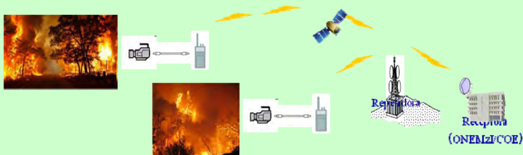
Figura 8 Sistema de Transmisión de Imágenes por Radio
