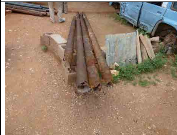
No.11 ゴデ市給水システム 腐食配水管 腐食し交換された亜鉛メッキ管。既存配水管網からの漏水が激しいと報告されている。
