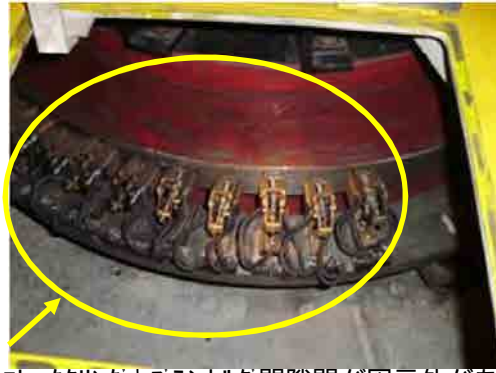
コレクタリングとブラシホルダ間隙間が図示外がある スケールにて隙間が3~6mm(図示2~4mm) Photo 42
