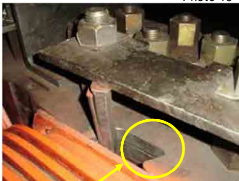
ポールコットのまくれ状況とナイターが下がりすぎ Photo 15
