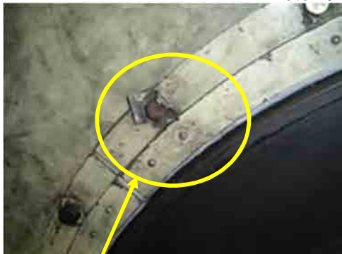
コレクターリングのシールカバー取付ボルトのロック不良:NG Photo 51
