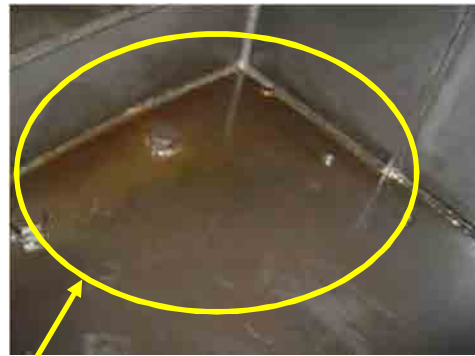
ロータスライダ-内にオイルミストの油溜り有り Photo 44
