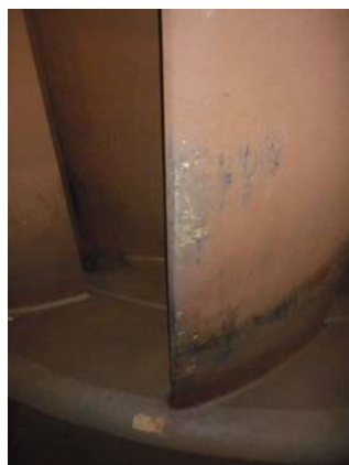
写真⑧ 2号機水車内部の流水部 整流羽根（ステーベーン）入口部
