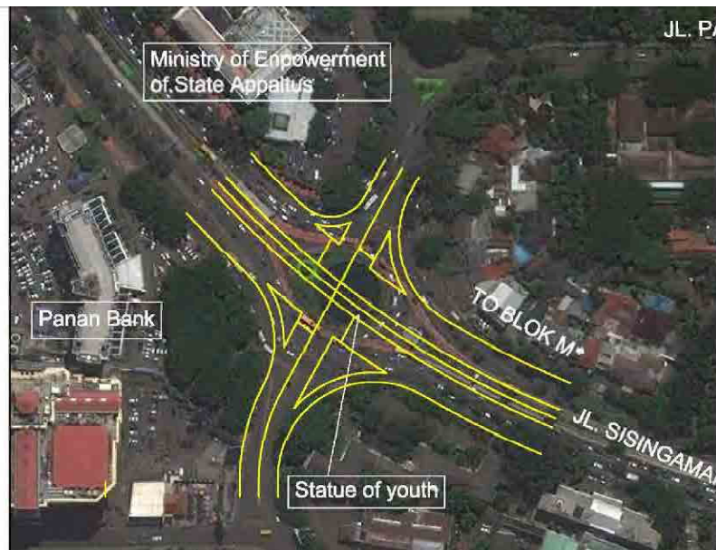
図 3.4.18 代替案 3: 平面交差点化
