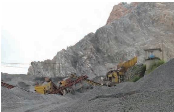
Hình 3.2.3-14 Mỏ đá có trang bị máy nghiền va đập
