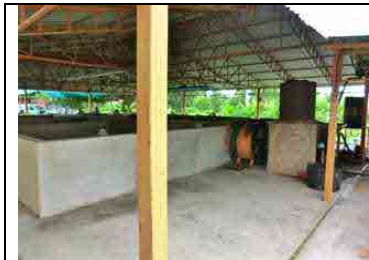
写真 41: AQIP 乾燥機:local made。 燃料は籾殻:コスト 15,000US$
