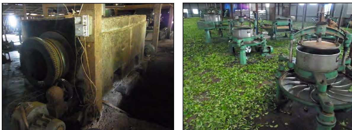
図 6-24 殺青する窯（左）と茶葉をもむ揉捻機（ポンサリー県）
