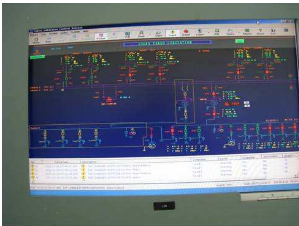
図3 開閉器の状態表示（緑が「開」、赤が「閉」）
