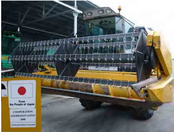
1. 2008 年度 2KR 調達 SAMP0 製コンバイン ハーベスターと ODA マーク (写真左下)
