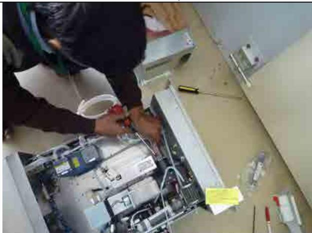
写真-5 大気自動測定局の修理作業
