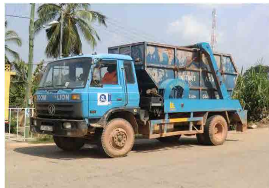
コンテナ収集システム
