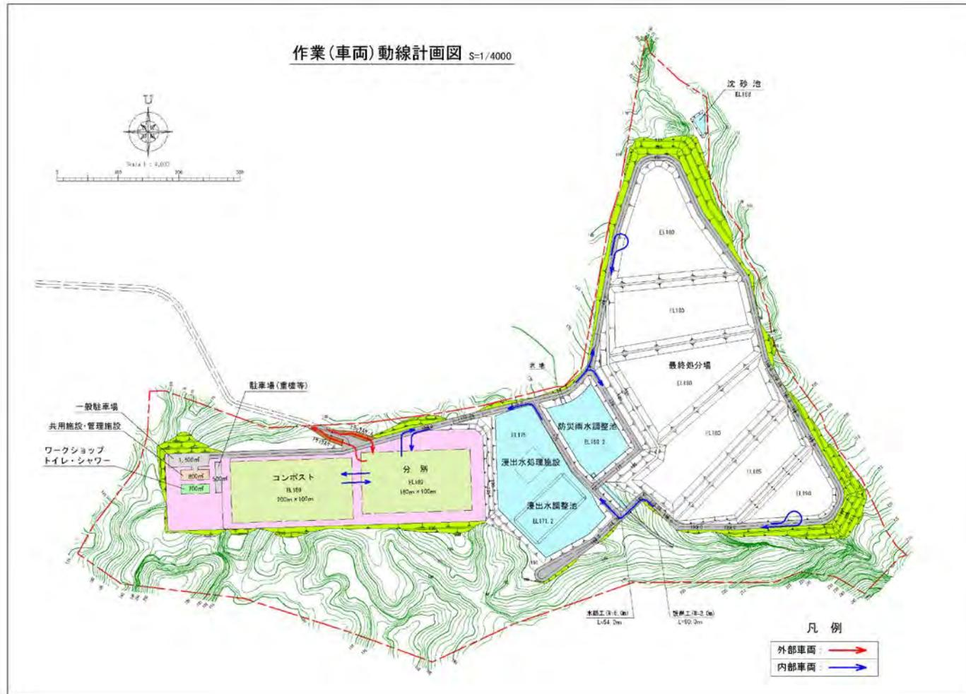
図 6-7 作業動線計画図
