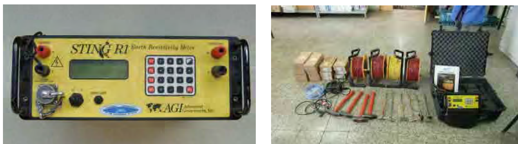
図 4.3: 使用した電気探査測定器
