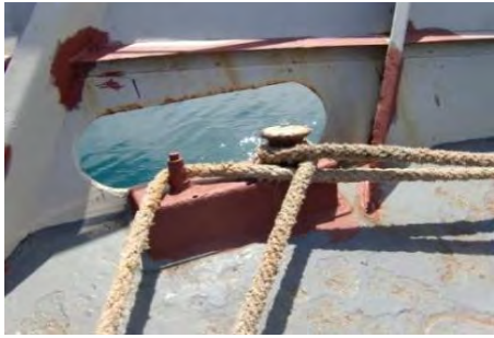
フェリーダーのローラーがない
