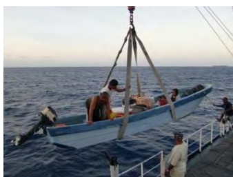
ボート吊り降し
