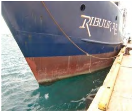
船体に若干の錆びがあるがきれいになっている
