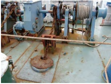
錆が多い揚錨機まわり
