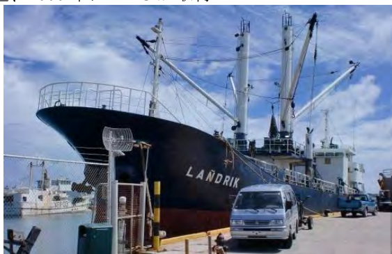
LANDRIK 号 全長 48.2m 貨客船 1985 年日本建造の光栄丸をデリック設置など改造、2000 年に MTC が取得
