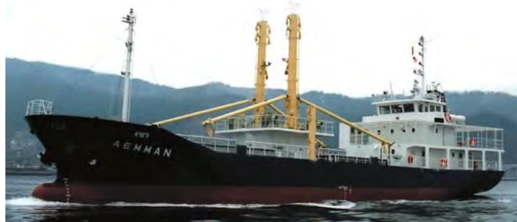
LANDRIK 号 全長 48.2m 貨客船 1985 年日本建造の光栄丸をデリック設置など改造、2000 年に MTC が取得
