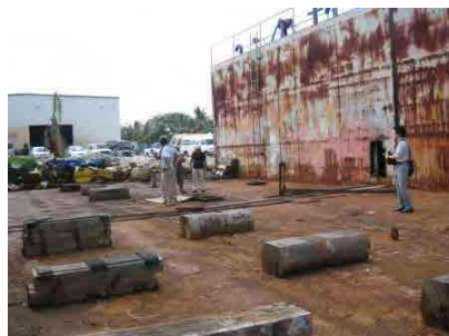
腐食が激しくいたるところに穴
