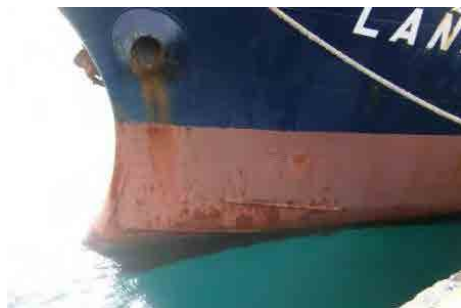
外板の傷み、水中部の汚れ
