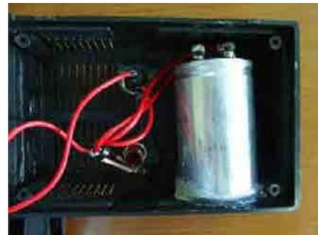
図 2.5.6-2 単体コンデンサ内部構造
