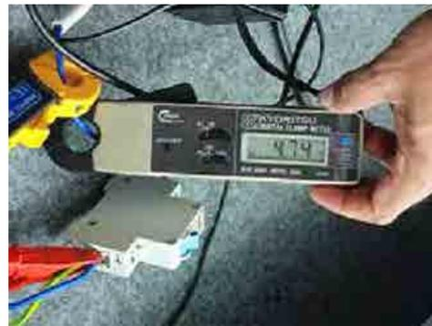
図 2.5.6-6 市販リミッタのトリップ確認実験 (ランプ負荷)
